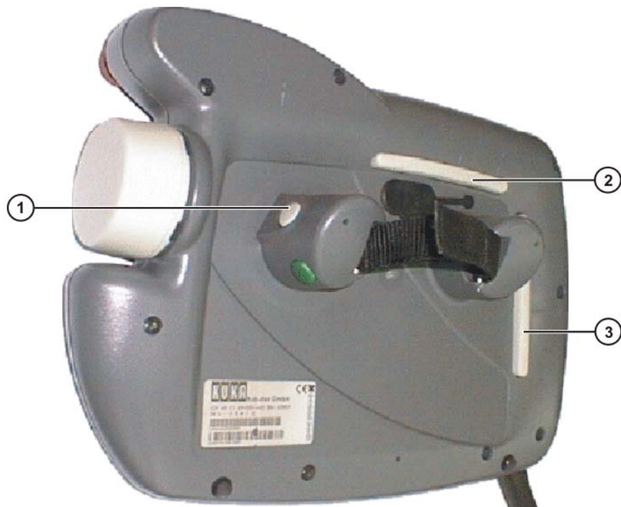
Fig. 3-4: Interrupteur d'homme mort au KCP
