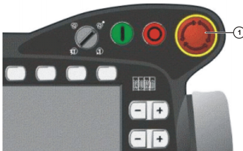
Fig. 3-3: Interrupteur d'ARRÊT D'URGENCE au KCP
