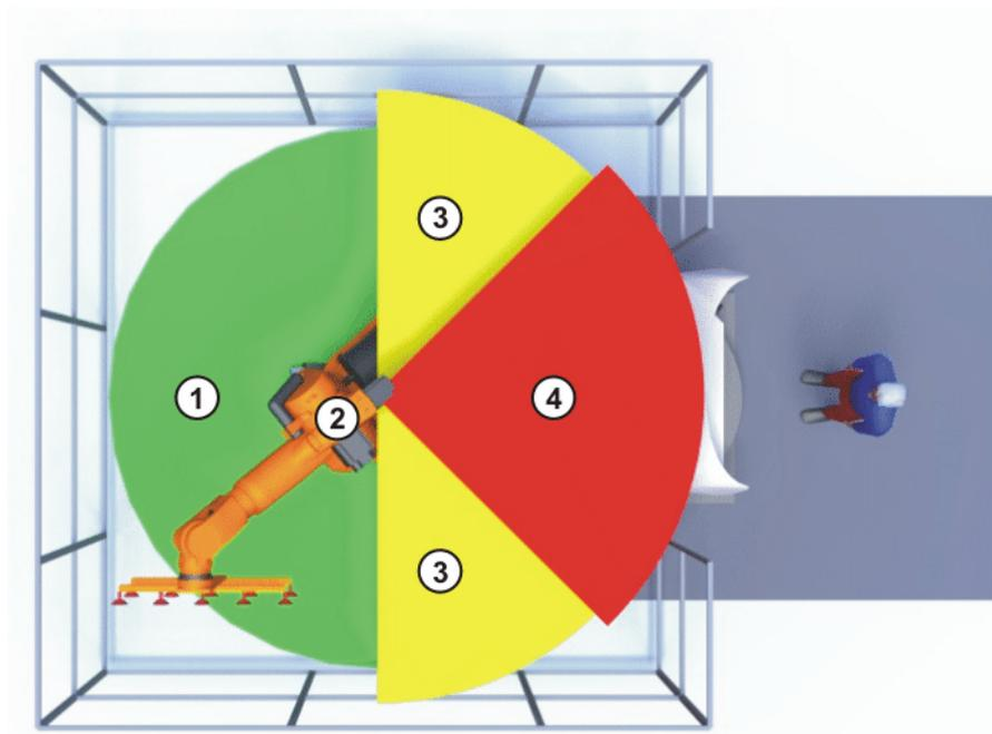
Fig. 3-1: Exemple enveloppe axe A1
