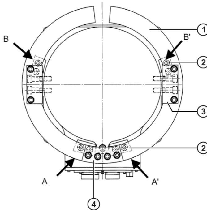
Fig. 4-2: Limitation mécanique de l'enveloppe de l'axe 1
