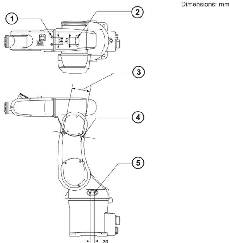
**Fig. 2-8: Filets de fixation**
