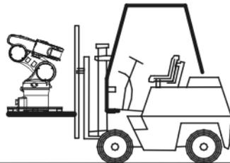
**Fig. 5-3: Transport avec chariot élévateur**
