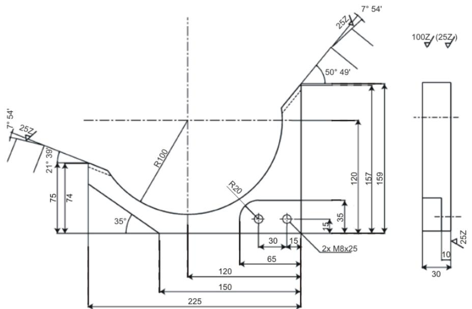
Fig. 6-5: Butée mécanique, plan coté
