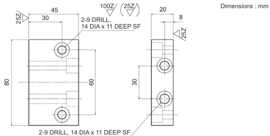
Fig. 6-2: Bloc de fixation A, plan coté
