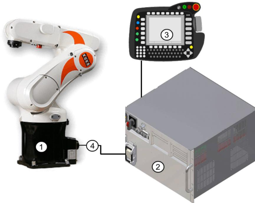
**Fig. 1-1: Exemple d'un système de robot**
