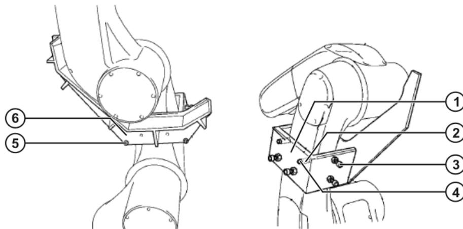
Fig. 4-5: Limitation mécanique de l'enveloppe de l'axe 3
