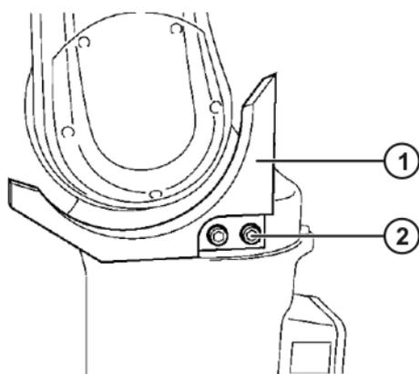
**Fig. 4-3: Limitation mécanique de l'enveloppe de l'axe 2**
