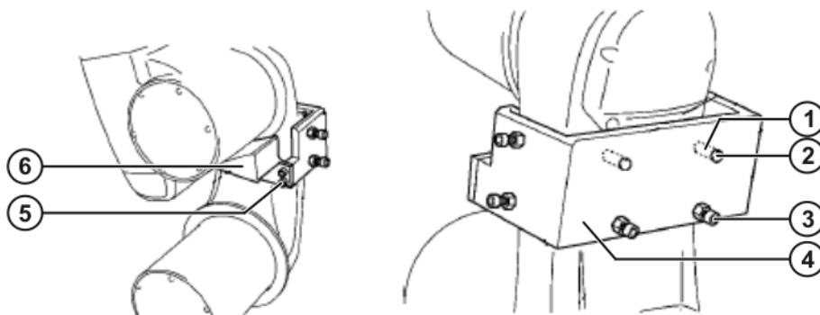
**Fig. 4-4: Limitation mécanique de l'enveloppe de l'axe 3**
