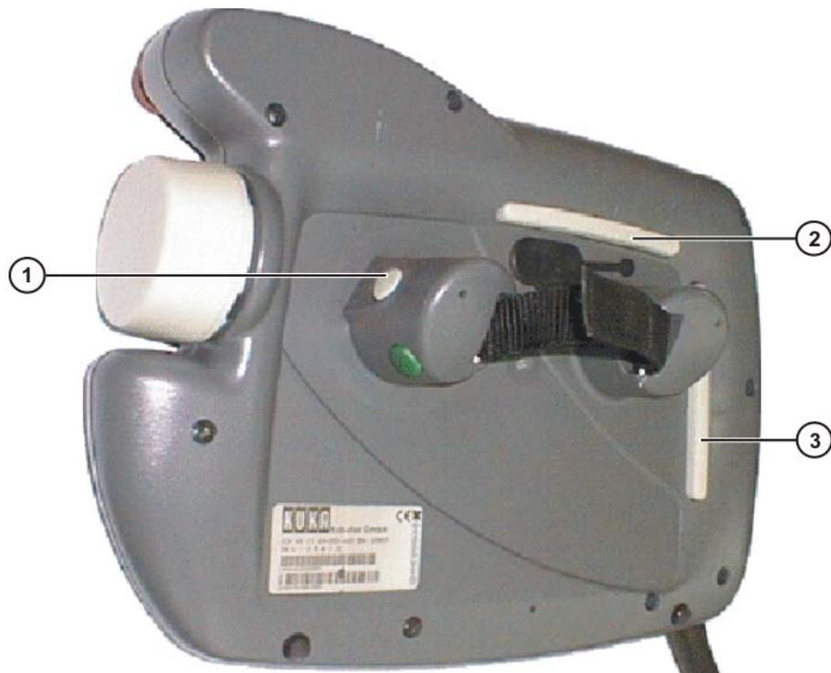
**Fig. 3-4: Interrupteur d'homme mort au KCP**
