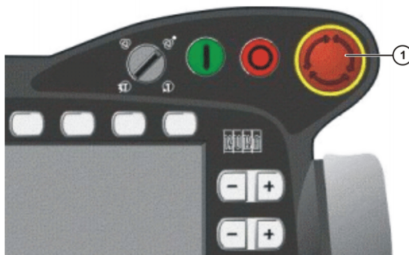
Fig. 3-3: Interrupteur d'ARRÊT D'URGENCE au KCP
