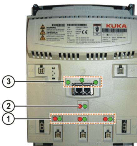
Fig. 12-12: Signalisation par LED du KSP
