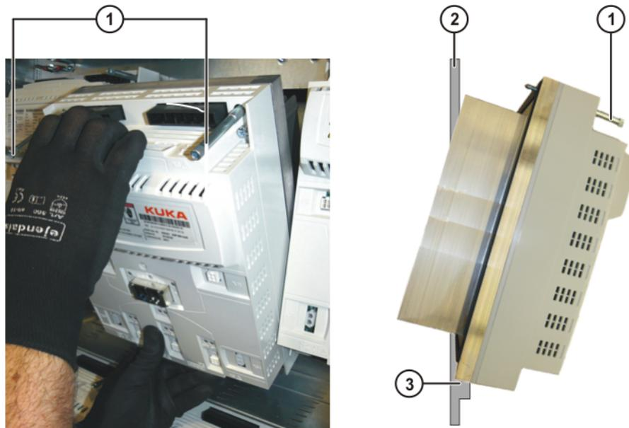
Fig. 11-15: Fixation KSP
