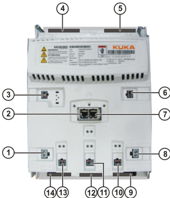
Fig. 11-13: Connexion KSP avec amplificateur pour 3 axes
