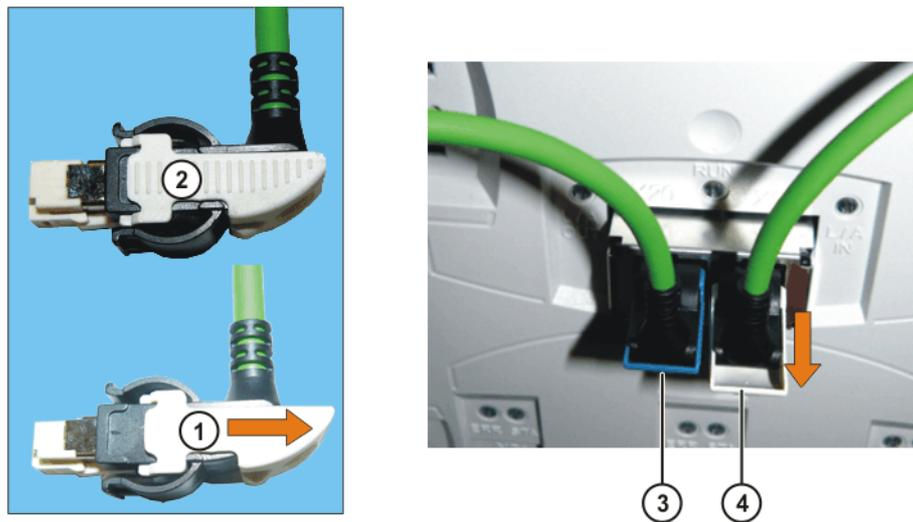
Fig. 11-11: Déverrouillage des connecteurs X20 et X21
