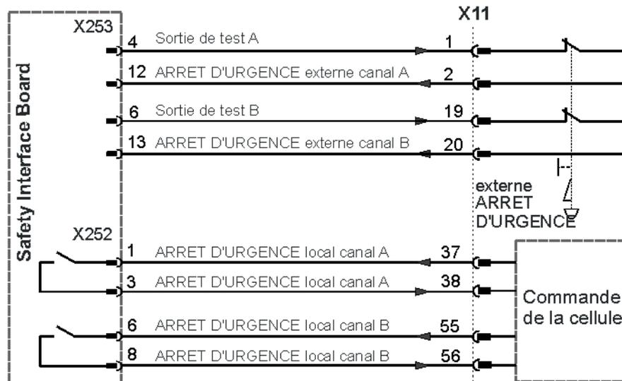
Fig. 6-10: Exemple de circuit : ARRET D'URGENCE
