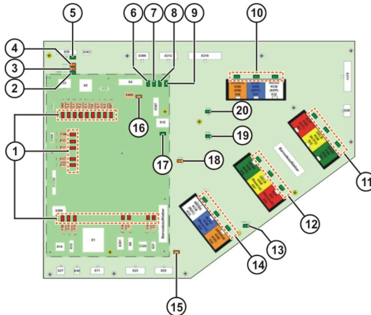
Fig. 12-1: Signalisation par LED de la CCU
