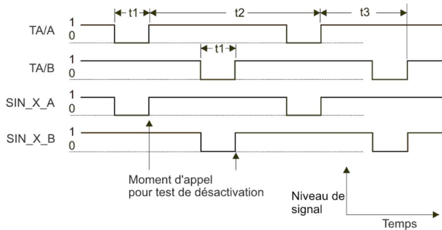
**Fig. 6-13: Schéma d'impulsions d'arrêt, sorties de test**
