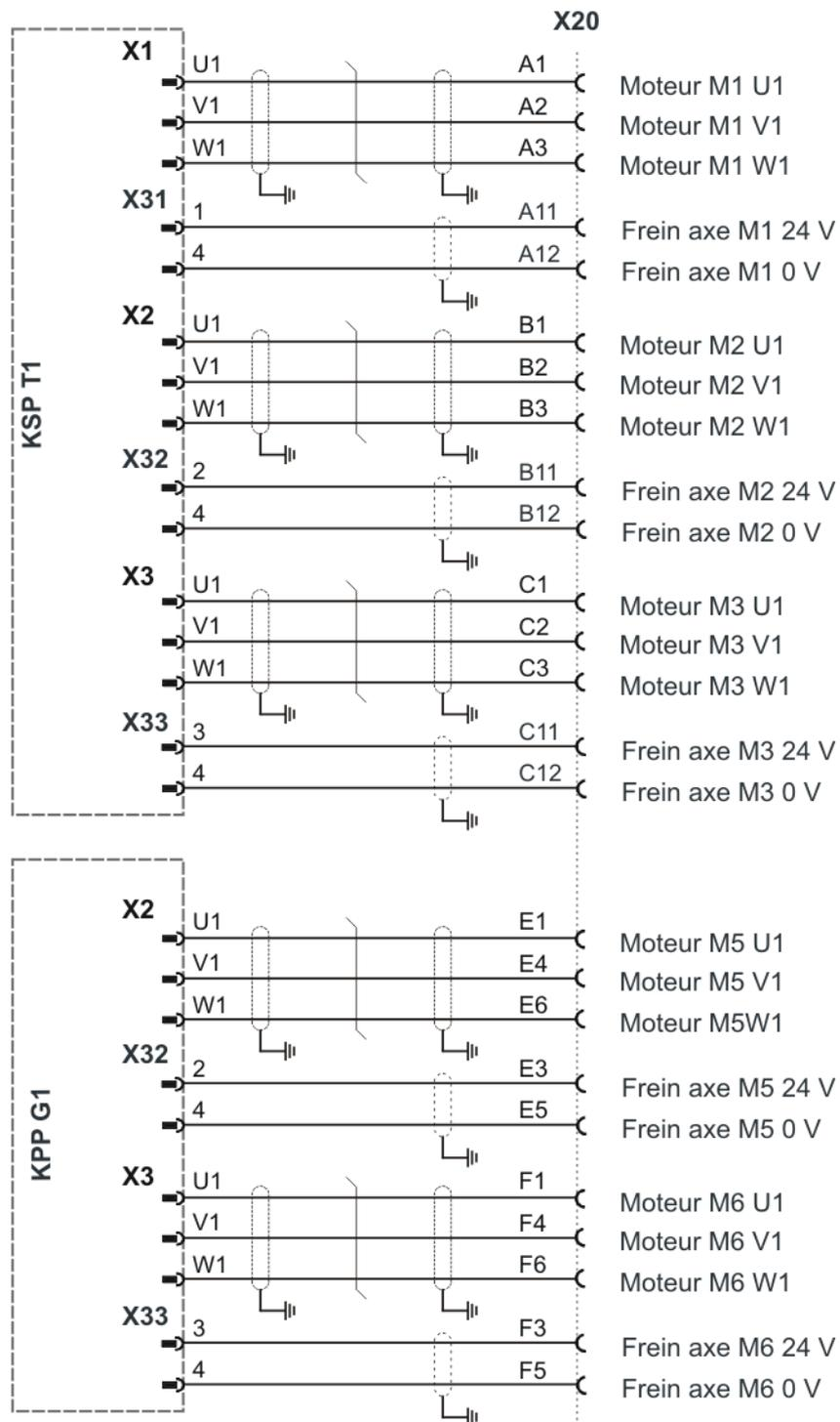
Fig. 3-15: Palettiseur à 5 axes, brochage X20
