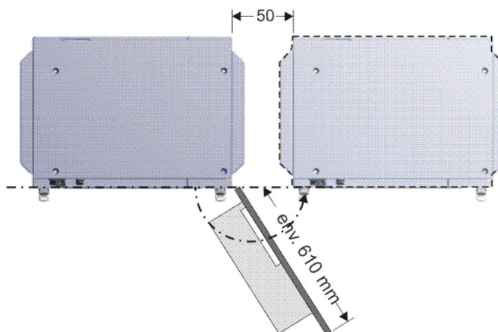
**Fig. 4-3: Plage de pivotement porte de l'armoire**
