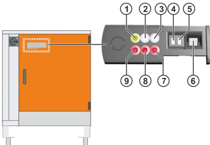
**Fig. 3-4: CSP, disposition des LED et des connecteurs**
