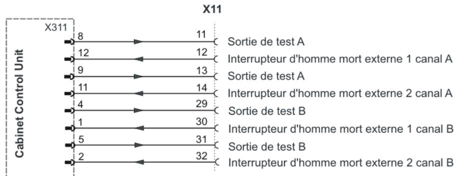
Fig. 6-8: Interface X11, brochage, interrupteur d'homme mort externe
