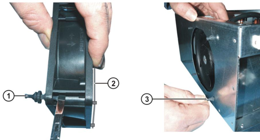
**Fig. 11-8: Montage du ventilateur du PC de commande**
