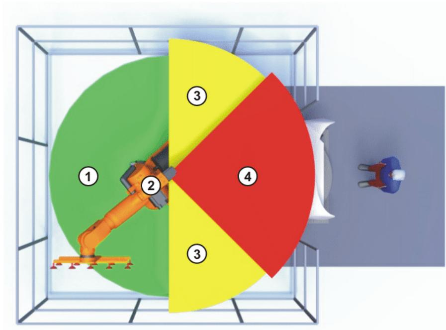
Fig. 5-1: Exemple enveloppe axe A1
