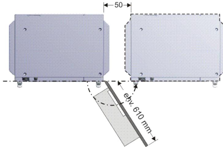
**Fig. 6-3: Plage de pivotement porte de l'armoire**
