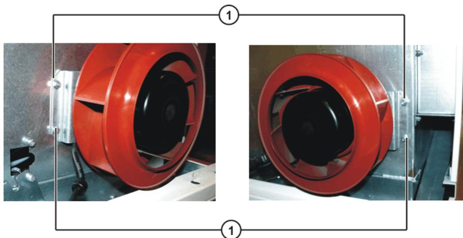
**Fig. 11-4: Remplacement du ventilateur externe**
