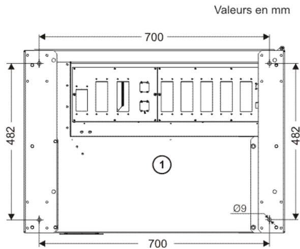
**Fig. 4-5: Taraudages pour la fixation au sol**
