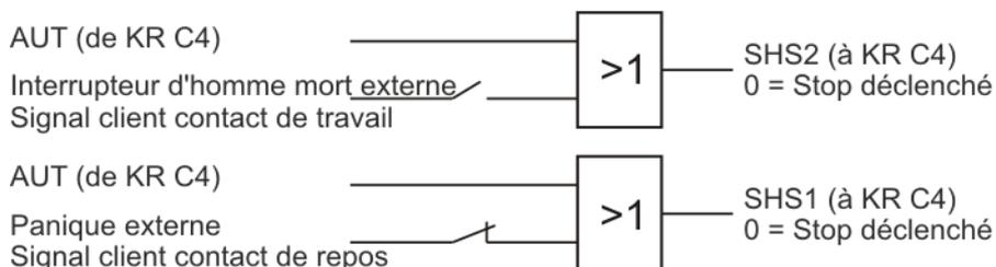
**Fig. 6-15: Interrupteur d'homme mort externe, schéma de principe**
