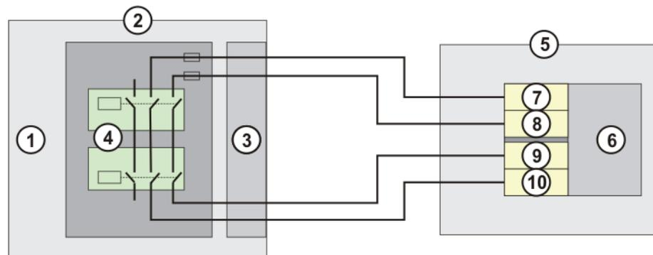
**Fig. 6-14: Principe de connexion pour sortie sûre**
