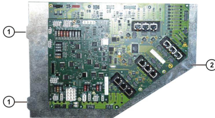
**Fig. 11-18: Fixation CCU**
