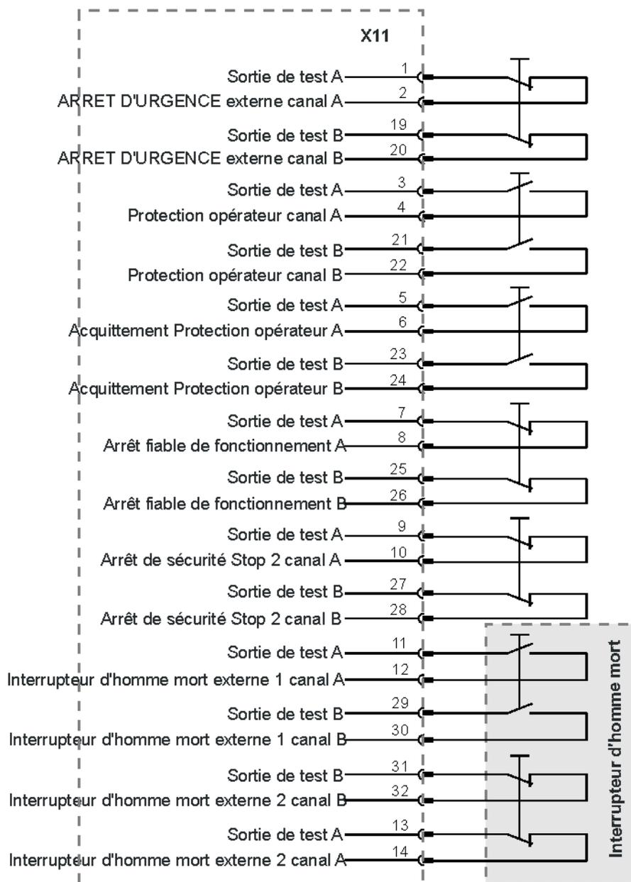
**Fig. 11-1: Exemple de circuit X11**
