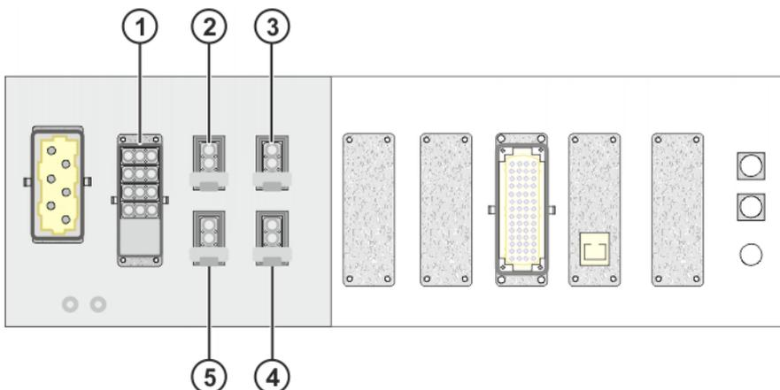
Fig. 3-18: Panneau de raccordement avec X81 et X7.1...X7.4
