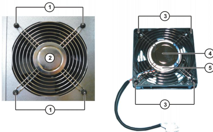
**Fig. 11-7: Structure du ventilateur pour PC**
