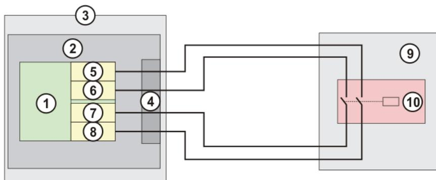
**Fig. 6-12: Principe de connexion pour entrée sûre**
