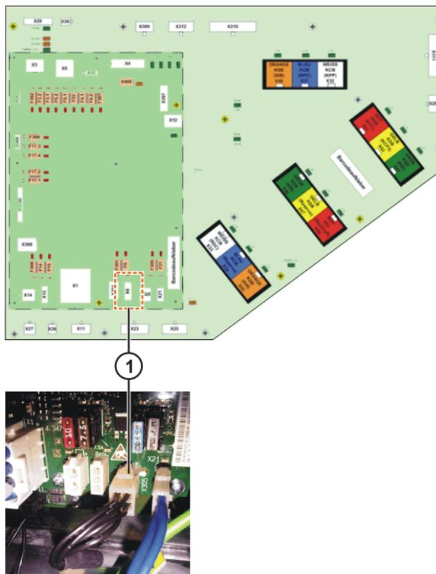
**Fig. 8-5: Protection de décharge des accu X305**
