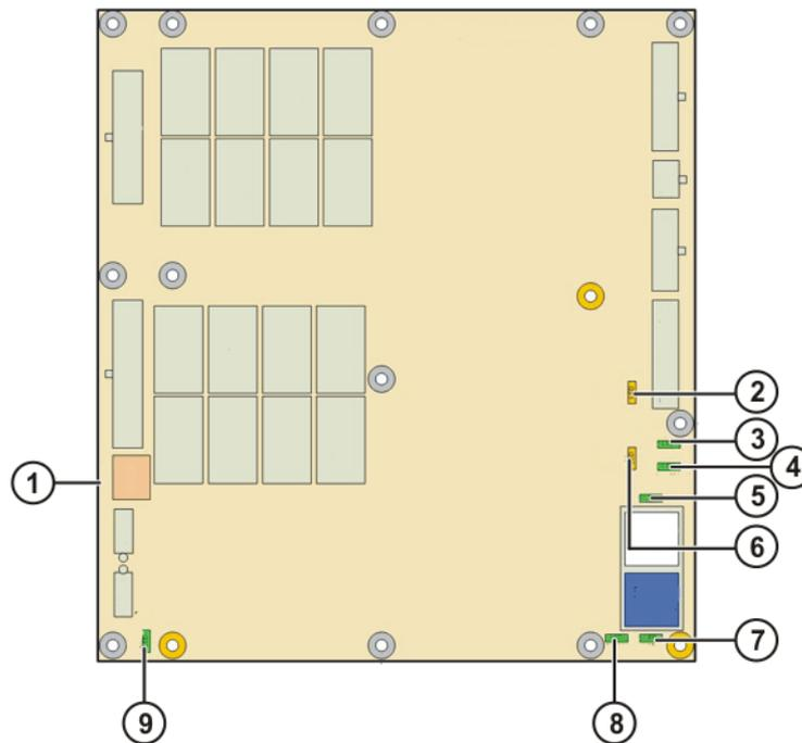
Fig. 12-9: Signalisation par LED, SIB Extended
