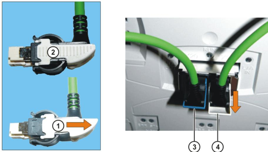
Fig. 11-14: Déverrouillage des connecteurs X20 et X21
