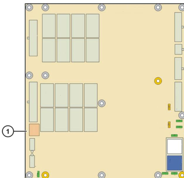
Fig. 12-11: Coupe-circuit SIB Extended
