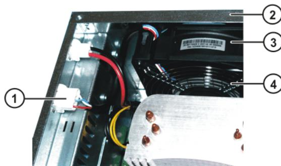
**Fig. 11-6: Débranchement du ventilateur du PC de commande**
