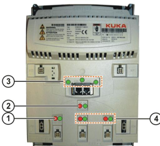
Fig. 12-13: Signalisation par LED du KPP
