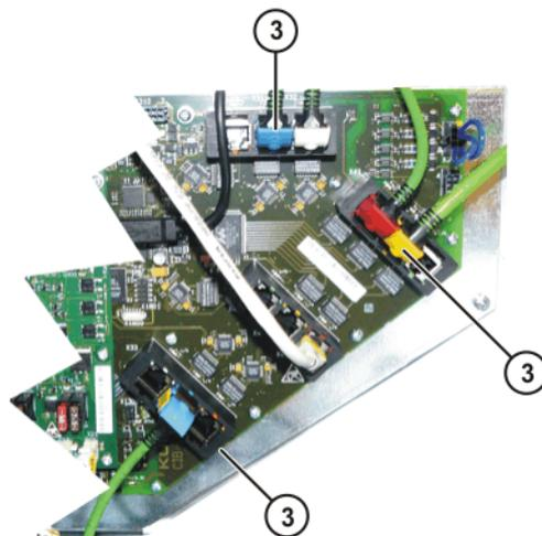
**Fig. 11-17: Déverrouiller les connecteurs des câbles de données**
