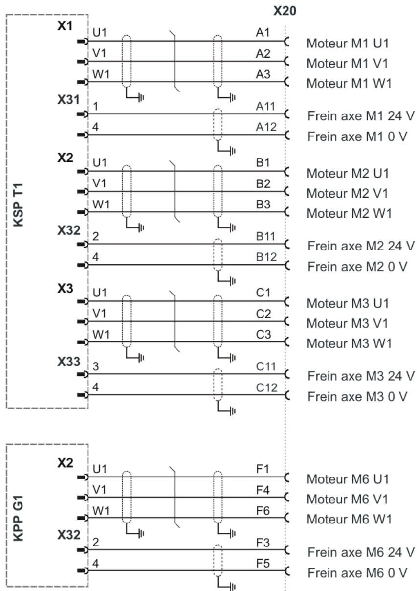
Fig. 3-13: Palettiseur à 4 axes, brochage X20
