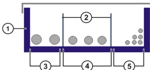
Fig. 8-1: Exemple : Pose des câbles dans la conduite de câbles
