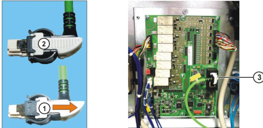
**Fig. 11-21: Déverrouillage des connecteurs des câbles de données**
