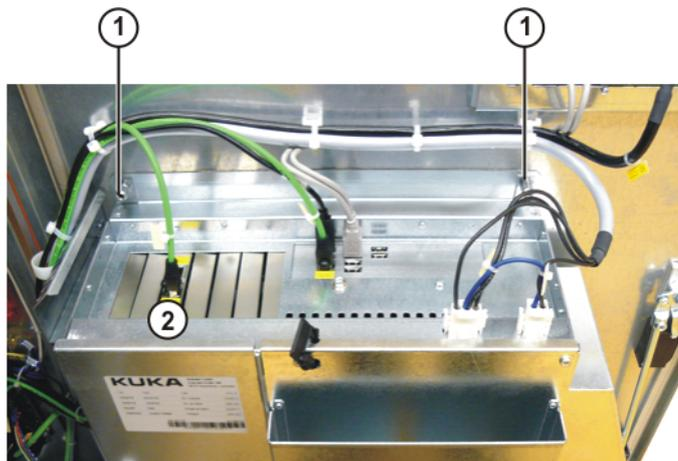
Fig. 11-5: Fixation du PC de commande avec la carte mère D2608-K
