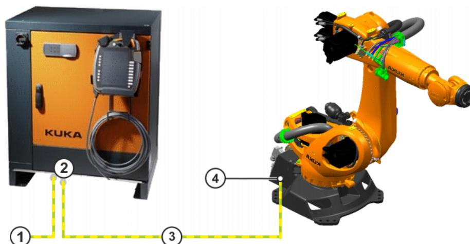
**Fig. 6-18: Compensation du potentiel commande du robot - manipulateur**
