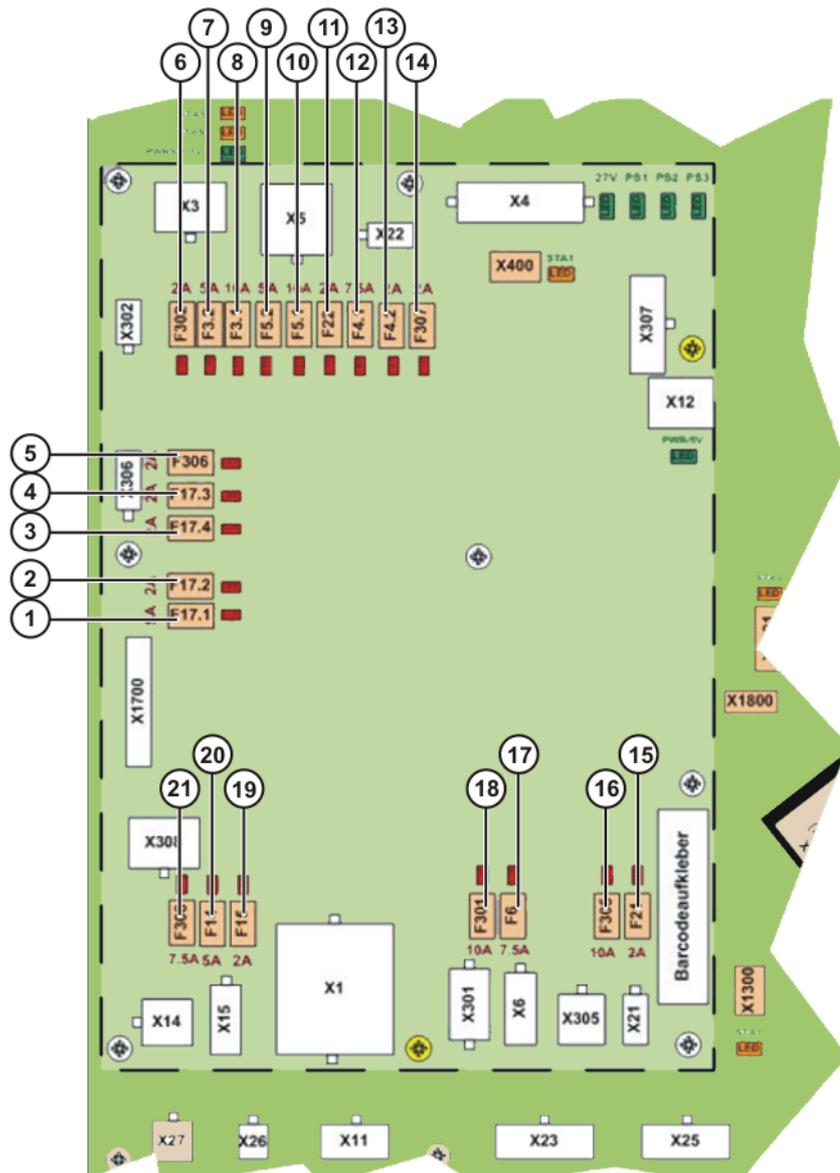
Fig. 12-2: Disposition des coupe-circuit
