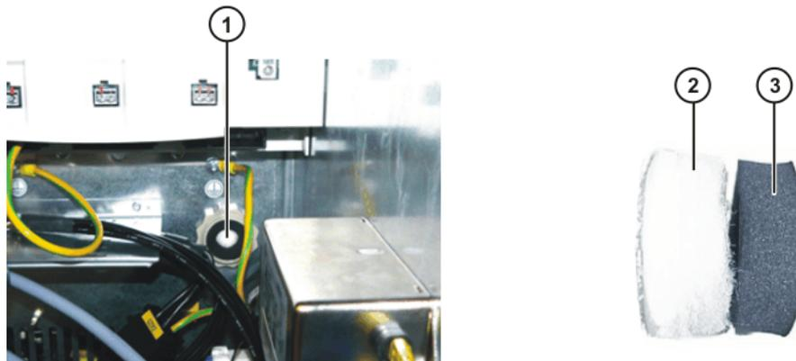
Fig. 11-30: Remplacement du bouchon de compensation de pression
