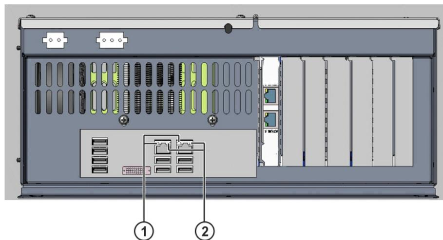
Fig. 12-7: Signalisation par LED, LAN Onboard
