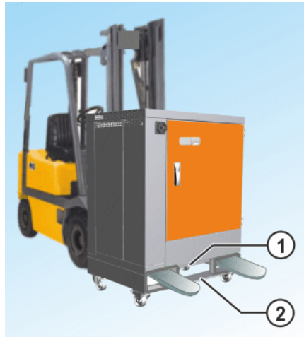
Fig. 7-3: Transport avec poches traversantes
