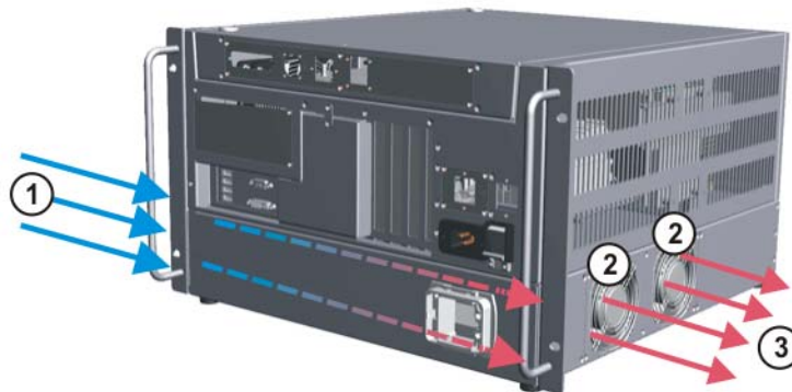
Fig. 3-8: Circuit de refroidissement de la boîte d'entraînement
