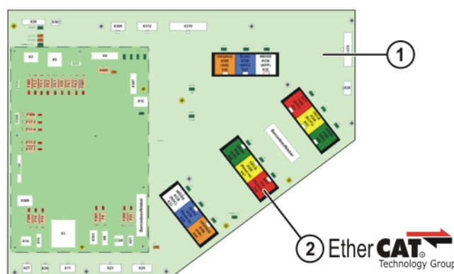
Fig. 6-15: EtherCAT, connexion X44
