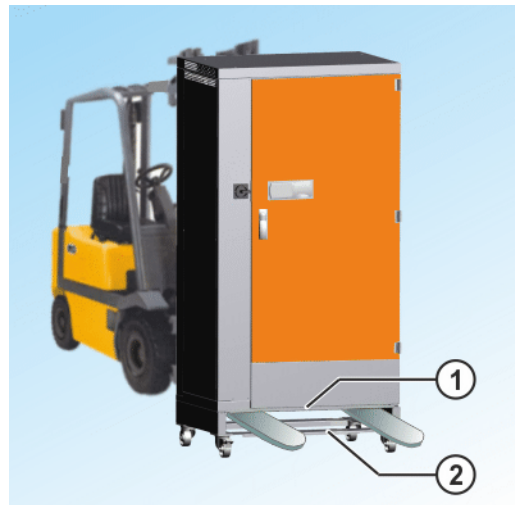
Fig. 7-5: Transport avec kit de montage de roulettes
