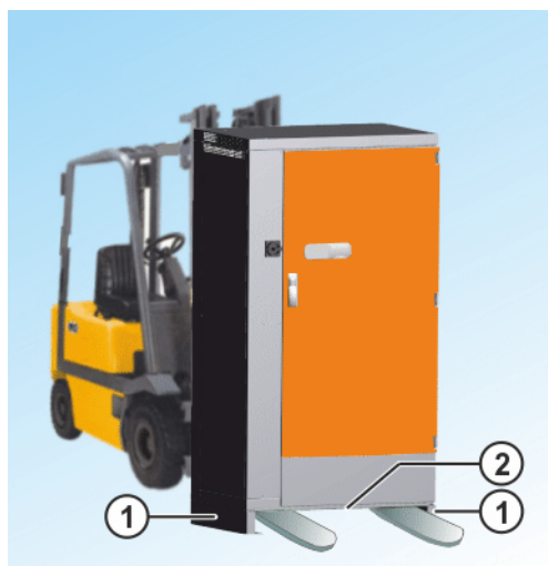
Fig. 7-2: Transport avec pied d'armoire standard
