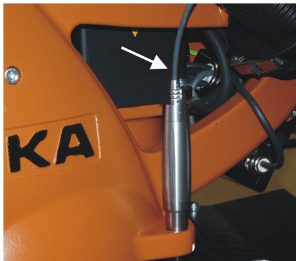
Fig. 5-9: Raccorder le câble de mesure à l'EMD
