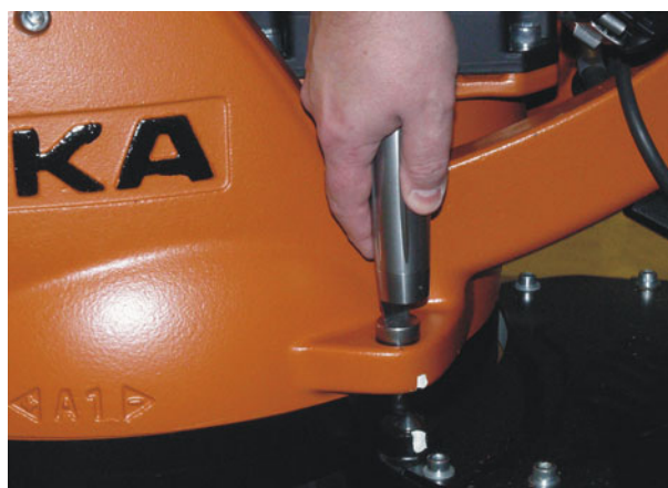
Fig. 5-7: Retirer le capuchon de protection de la cartouche de mesure
