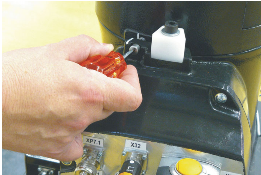
Fig. 5-15: Retirer le capuchon de protection de la cartouche de mesure
