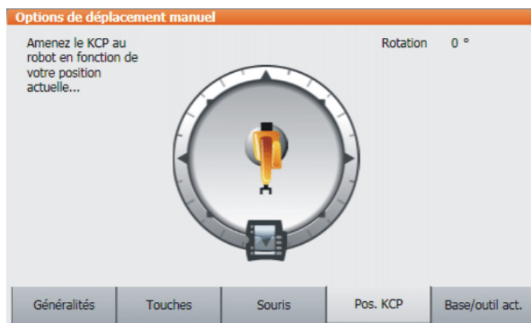
Fig. 4-22: Définir l'orientation de la Space Mouse
