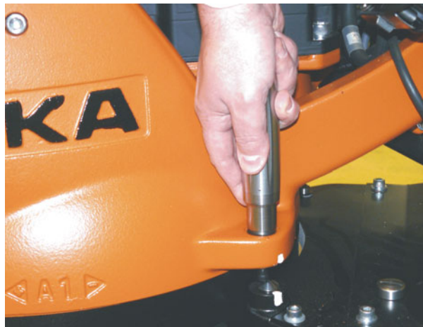
Fig. 5-8: Visser l'EMD sur la cartouche de mesure
