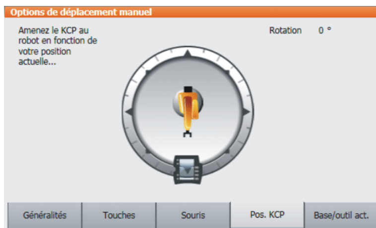
Fig. 4-22: Définir l'orientation de la Space Mouse
