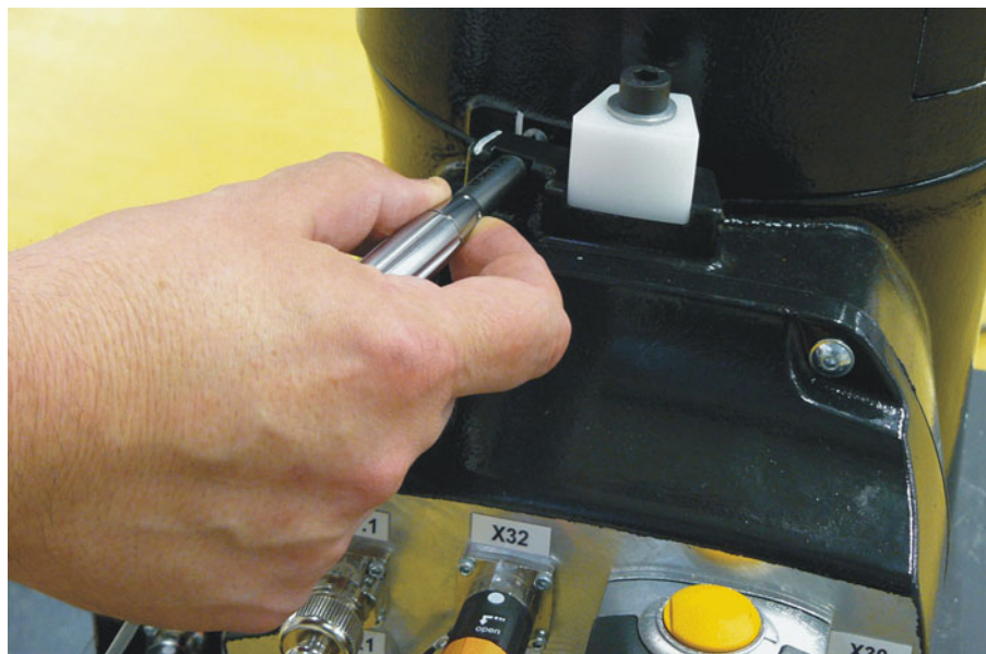
Fig. 5-16: Visser le MEMD sur la cartouche de mesure
