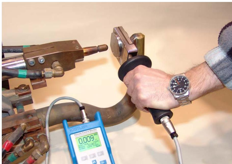
Fig. 6-5: Mesure avec statimètre
