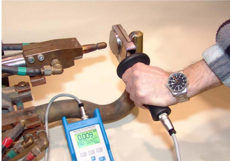
Fig. 6-8: Mesure avec statimètre
